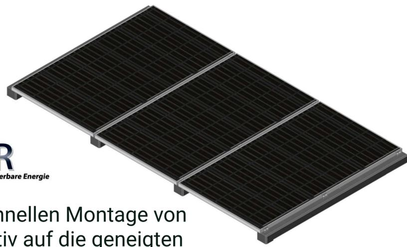
**B**etonsockel aus feinem Sichtbeton zur einfachen und schnellen Montage von PV-Modulen ohne Aufbohren der Dachstruktur. Module intuitiv auf die geneigten Betonflächen auflegen und mit Modulklemmen an den integrierten Gewinden festziehen.
