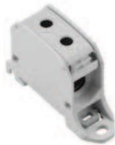
Klippon<sup>®</sup> Connect-Einspeisereihenklemmen WPD ermöglichen eine einfache und sichere Installation von Aluminium- und Kupferleitern auf engstem Raum. Optional ist auch die Nutzung eines Stromversorgungs- oder Überwachungsanschlusses möglich. Die Einspeisereihenklemmen WPD können unabhängig vom Leiterwerkstoff flexibel eingesetzt werden. Die Montage erfolgt entweder direkt oder auf einer DIN-Tragschiene TS35.
