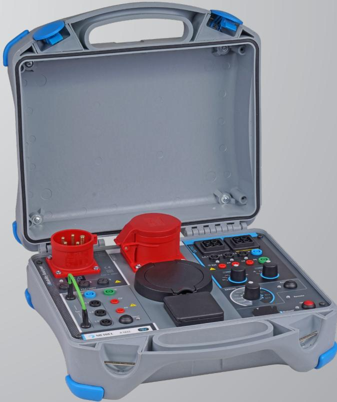
Der A 1632 eMobility Analyser ist ein Diagnoseadapter für die Überprüfung von Ladestationen (EVSE) und deren Zubehör. Er arbeitet mit den Metrel Installationstestern zusammen und unterstützt die Überprüfung der elektrischen Sicherheit sowie der Funktionsprüfung, Typ 1/Typ 2 Ladesäulen, Mode 2 (ICCB) / Mode 3 Ladekabel (EV) und die Überwachung der Kommunikation während der Ladung können überprüft werden. In dem Metrel ES Manager erfolgt nach dem Speichern der Ergebnisse die Berichterstellung.
