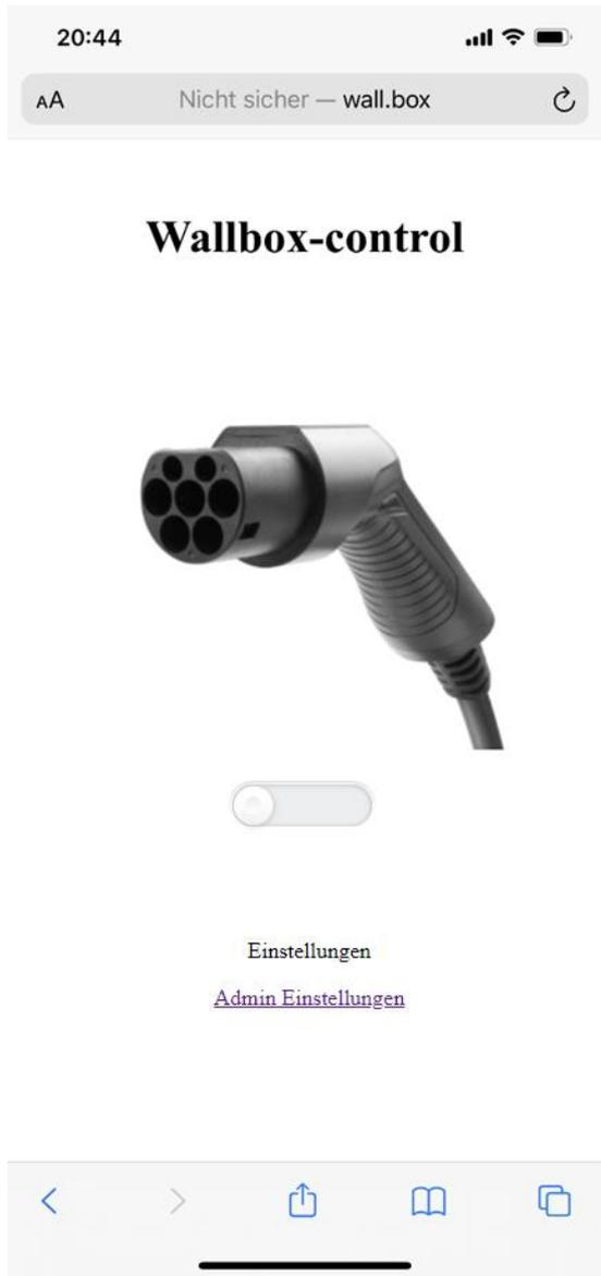
Nach einer kurzen Zeit sollten Sie die Bedienoberfläche, wie links in der Abb. , erhalten. Sollte die Bedienoberfläche nicht erscheinen, dann ist vermutlich die Verbindung zum WiFi-Netzwerk „Wallbox-control“ unterbrochen. wiederholen Sie in diesem Fall die Unterschritte von Schritt 1.
