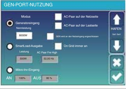
**Nennleistungsleistung des Generators:** zulässig max. Strom vom Dieselgenerator.
