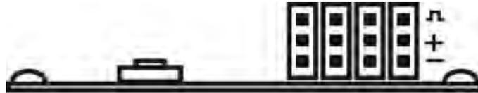
In dieser Ansicht (Rückansicht) ist der Steckplatz für die Neigefunktion auf dem ganz rechten Steckplatz. Die Rollfunktion wird direkt links daneben eingesteckt. **Entfernen Sie jedoch bei beiden JR Steckern unbedingt das rote Pluskabel da der Controller direkt mit Strom versorgt und das Kabel nicht benötigt wird. Achten Sie beim Verbinden der Kabel auf die korrekte Polarität**
