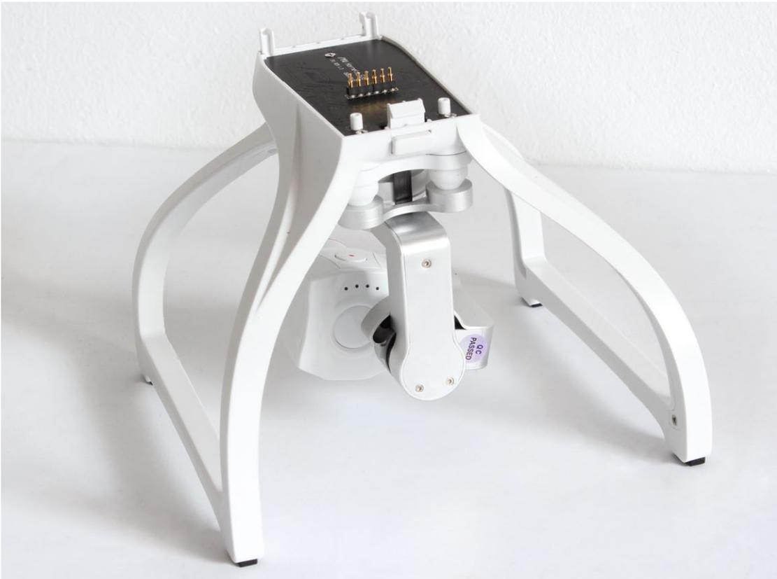
Die Gimbal-Kamera ist in das Landegestell integriert. Um sie zu installieren, wird das ganz Bauteil einfach auf der Unterseite des Kopters angeklipst
