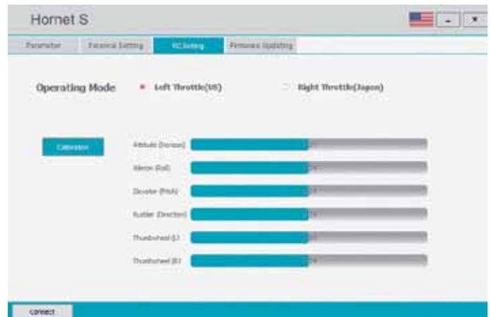
Über die Hornet-Software kann der Kopter kalibriert werden. Darüber hinaus besteht die Möglichkeit, Parameter zu verändern
