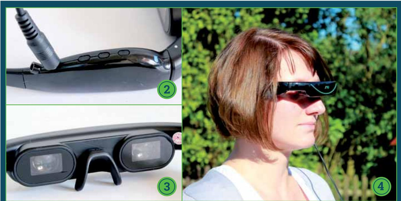
Die separat erhältliche FPV-Brille (1) wird mittels Klinkenstecker am Sender angeschlossen (2). Obwohl sie etwas breiter hätte sein dürfen (3), lässt sie sich recht bequem tragen. Störend ist lediglich der fehlende Sonnenschutz (4)
