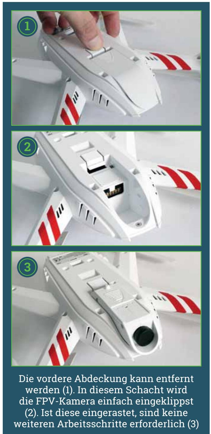
Die vordere Abdeckung kann entfernt werden (1). In diesem Schacht wird die FPV-Kamera einfach eingeklippt (2). Ist diese eingerastet, sind keine weiteren Arbeitsschritte erforderlich (3)
