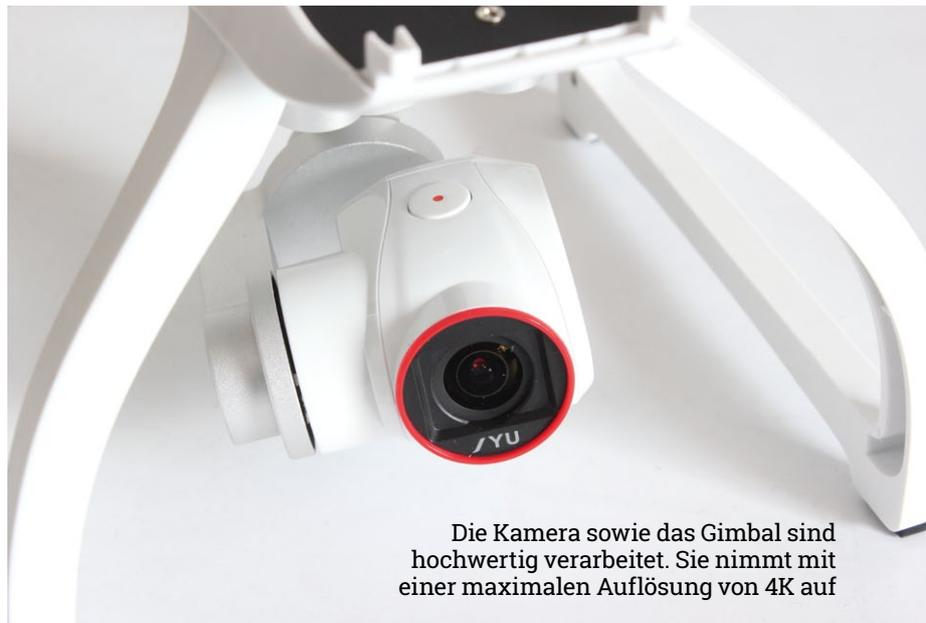
Die Kamera sowie das Gimbal sind hochwertig verarbeitet. Sie nimmt mit einer maximalen Auflösung von 4K auf
