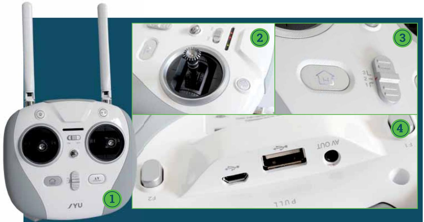
Der Sender macht einen sehr edlen, hochwertig verarbeiteten Eindruck (1). Die Kreuzknüppel verfügen über ein gutes Rückstellmoment (2) und die übrigen Bedienelemente sind nicht nur sehr gut erreichbar, sondern auch Hintergrundbeleuchtet (3). Auf der Rückseite finden sich verschiedene Anschluss-Möglichkeiten (4)
